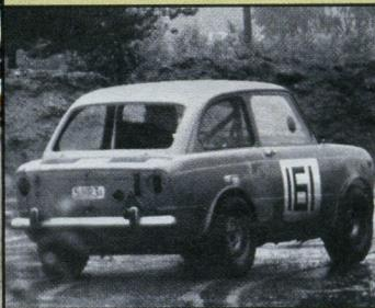
veny byly i zámky dveří, kotevní místa bezpečnostních pásů i přístrojová deska. Průměrná spotřeba se pohybovala kolem 7 l/100 km. Ke dvěma verzím (Normal s motorem 843 cm<sup>3</sup>/34 k, Super 843 cm<sup>3</sup>/37 k) s bubnovými brzdami a plně synchronizovanou čtyřstupňovou převodovkou přibyl v roce 1968 model 850 Special (na horním snímku) s kotoučovými brzdami na předních ko-
